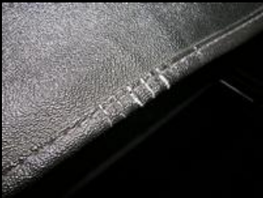
Funktionierte auch auf den Rissen an der Vinyldachkante
